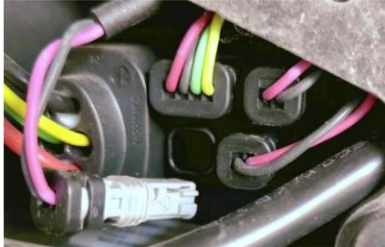
4. Stecken Sie das Kabel des SpeedMods in den Motor ein und das ausgesteckte Sensorkabel in den SpeedMod. Achten Sie darauf, dass beide Stecker eingerastet sind. Suchen Sie eine geeignete Stelle für den Speedmod und befestigen Sie ihn mit Kabelbindern.
