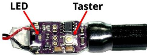
Zum Auswählen des Modus wird der Taster gedrückt. Nachdem der Taster losgelassen wurde blinkt die LED, entsprechend des aktuellen Modus. Dies geht von ein bis fünf Mal blinken, entsprechend Modus eins bis fünf.
