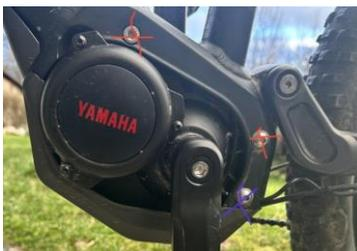
3. Stecken Sie den SpeedMod zwischen Motor und Geschwindigkeitssensor ein. Dies ist der einzige 3 polige Steckverbinder. Achten Sie dabei darauf die Verriegelungs-Clips an den Steckverbindern zu lösen. Achten Sie darauf, dass beide Stecker vollständig eingesteckt sind.
