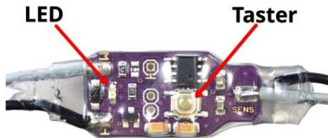
Zum Auswählen des Modus wird der Taster gedrückt. Nachdem der Taster losgelassen wurde blinkt die LED, entsprechend des aktuellen Modus. Dies geht von ein bis fünf Mal blinken, entsprechend Modus eins bis fünf.
