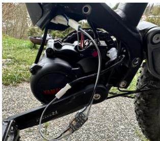
4. Suchen Sie eine geeignete Stelle für den SpeedMod und befestigen Sie ihn mit Kabelbindern.
